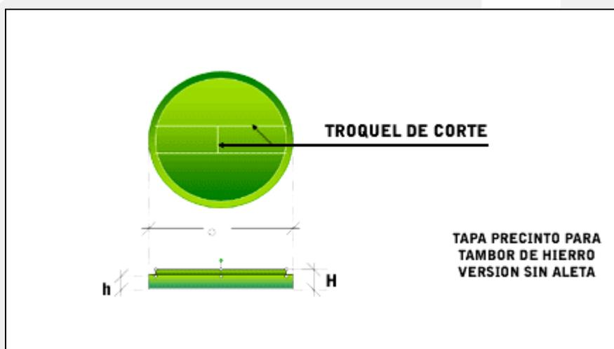
2" (nominal: diámetro interior (D) 69,3 mm. - altura (h) 9,7 mm.
