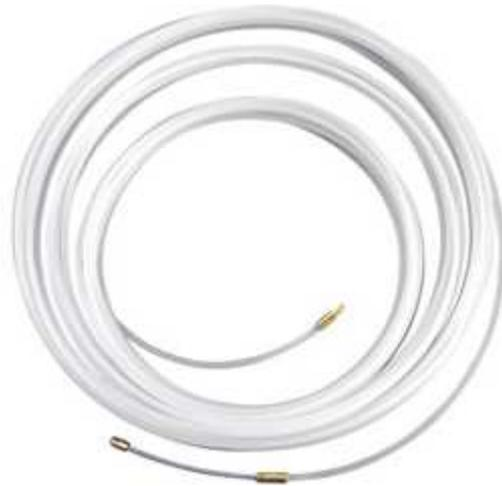
Fabricada en monofilamento de nylon virgen 6/6 de 3.8 mm de diámetro, lo que ofrece una mayor resistencia a la tracción con más flexibilidad, puntera buscadora flexible con OJAL DE TIRO, y amplia puntera tiracables de bronce fresado para evitar atascamientos. Ambas punteras van roscadas y prensadas hexagonalmente al nylon ofreciendo una resistencia a la tracción de 165 Kgf en la puntera tiradora y 100 Kgf en la puntera flexible con ojal.
