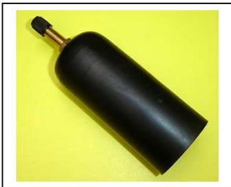
En el caso de capuchones para cables telefónicos presurizables, pueden estar provistos por una válvula de presurización, permitiendo de este modo un almacenamiento por un largo período de tiempo, sin riesgo de ingreso de humedad en el cable.
