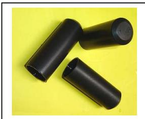
Los capuchones termocontraíbles son utilizados para proteger los extremos de los cables contra el ingreso de humedad y agentes contaminantes durante el almacenamiento o transporte. Su instalación es simple y rápida.
